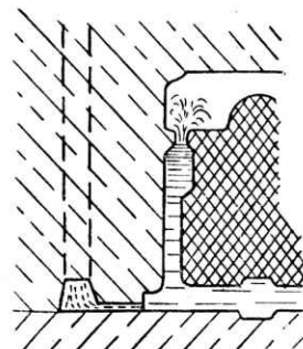
Obr. 57. Vznik fontány ve formě při přechodu ze širokého do úzkého průřezu při velké rychlosti plnění formy
